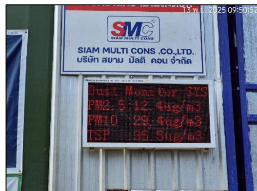
ภาพที่ 5 เครื่องตรวจวัดคุณภาพสิ่งแวดล้อมแบบ Real Time
